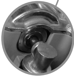
Posición del motor bloqueado : La espiga tiene que estar en posición salida
