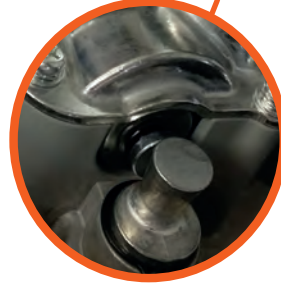
Posición del motor desbloqueado : La espiga tiene que estar en posición pulsada
